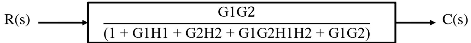
$$\frac{C(s)}{R(s)} = \frac{G_1G_2}{1 + G_1H_1 + G_2H_2 + G_1G_2H_1H_2 + G_1G_2}$$
