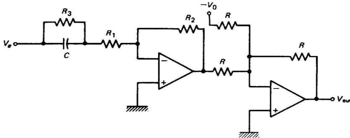
$$V_{out} = \left( \frac{R_2}{R_1 + R_3} \right) V_e + \left( \frac{R_2}{R_1 + R_3} \right) R_3 C \frac{dV_e}{dt} + V_0$$
